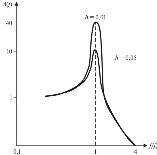
**Рис. 1.** Амплитудно-частотная характеристика (АЧХ) упругой системы
