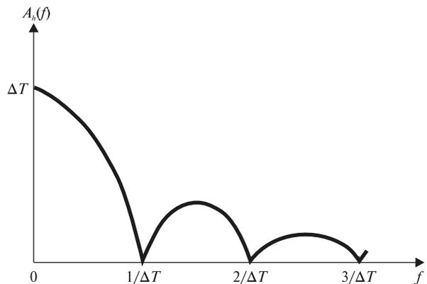
Рис. 5. Фурье-образ амплитудной компоненты импульсной функции  $H(\tau)$
