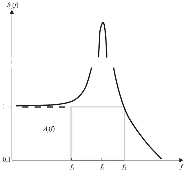
Рис. 7. Амплитудный спектр цикла  $S_c(f)$  и АЧХ полосового фильтра  $A(f)$
