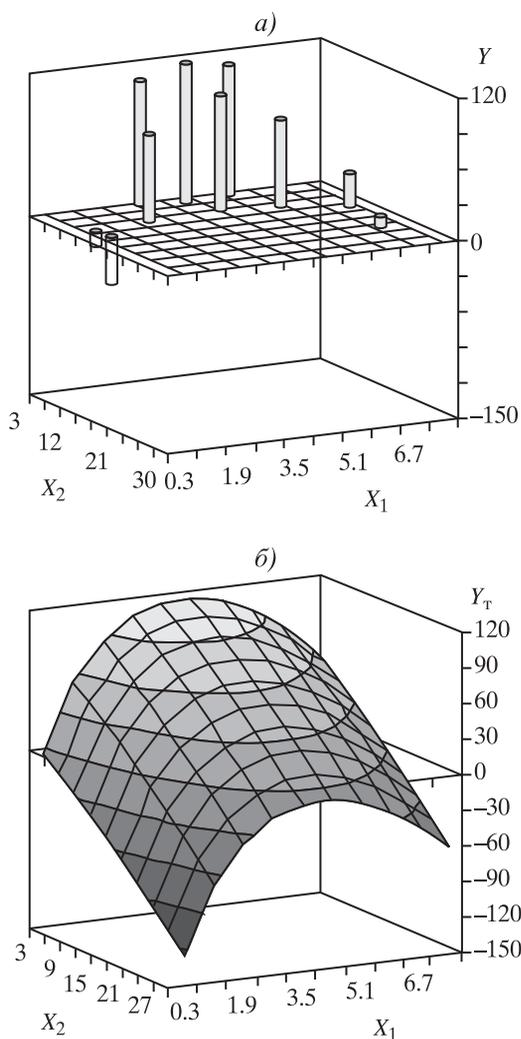
**Рис. 5.** Пример построения трехмерного полиномиального степенного тренда ПС СПС типа  $A - X_1(\mu_{11}, \mu_{12})X_2(\mu_{21})$ ,  $Y_T = 119.1X_1^{0.62} - 12.18X_1^{1.58} + 2.11X_2^{1.21} - 50.3$ ,  $\delta = 10^{-4}$ ,  $R^2 = 0.9987$ : *a* – распределение исходных данных; *б* – поверхность тренда
