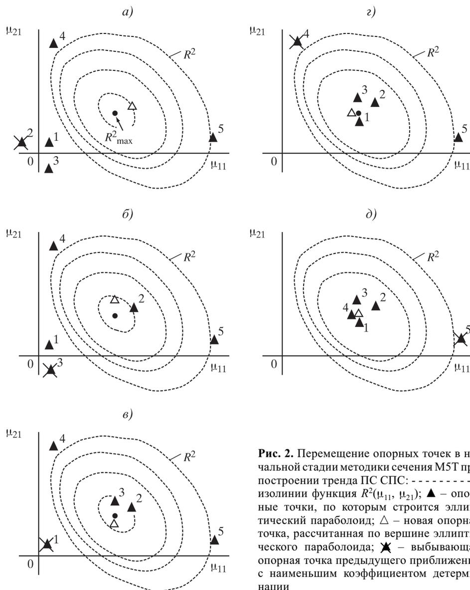
**Рис. 2.** Перемещение опорных точек в начальной стадии методики сечения МСТ при построении тренда ПС СПС: ----- изолинии функция  $R^2(\mu_{11}, \mu_{21})$ ; ▲ – опорные точки, по которым строится эллиптический параболоид; Δ – новая опорная точка, рассчитанная по вершине эллиптического параболоида; ★ – выбывающая опорная точка предыдущего приближения с наименьшим коэффициентом детерминации
