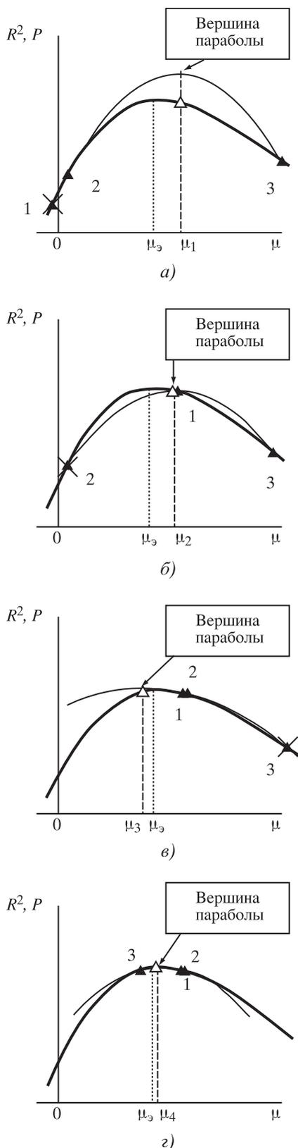
**Рис. 1.** Перемещение опорных точек в начальной стадии методики сечения МЗТ при построении тренда ПС СПС: ———— — функция  $R^2(\mu)$ ; ———— — парабла  $P(\mu)$ ; ▲ — опорные точки, по которым строится парабла; △ — новая опорная точка, рассчитанная по вершине параболы; ★ — выбывающая опорная точка предыдущего приближения с наименьшим коэффициентом детерминации
