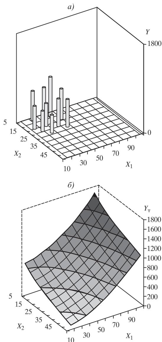
**Рис. 4.** Пример построения трехмерного полиномиального степенного тренда ПС СПС типа  $A - X_1(\mu_{11})X_2(\mu_{21})$ ,  $Y_T = 0.219X_1^{1.83} - 104.11X_2^{0.52} + 883.26$ ,  $\delta = 10^{-4}$ ,  $R^2 = 0.9707$ : а – распределение исходных данных; б – поверхность тренда
