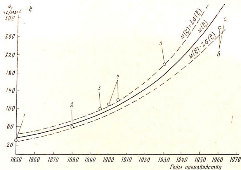
Рис. 1. Изменение характеристик прочности сталей: 1 — пудлинговая сталь; 2 — мартеновская (конверторная) углеродистая; 3 — мартеновская малолегированная; 4 — мартеновская легированная; 5 — высоколегированная электросталь; 6 — электровакуумная высоколегированная сталь
