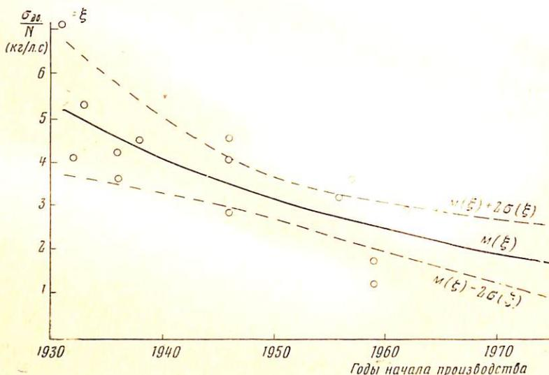
Рис. 2. Изменение весовых характеристик автомобильных двигателей
